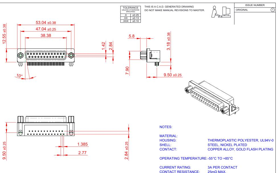
**INSULATOR RESISTANCE:** 5000MΩ min. DIELECTRIC
